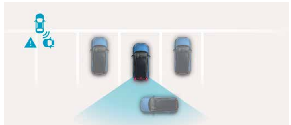
Pri vzratni vožnji sistem za preprečevanje trkov pri prečnem prometu opozori voznika, če se vozila približujejo s strani, prav tako tudi samodejno zavira. ◊
